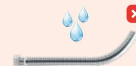
Comprobar la toma de tierra de los electrodomésticos (aparatos de aire acondicionado, bañeras, etc) conectado a flexibles ya que cualquier dispersión eléctrica puede provocar la corrosión del flexible.
