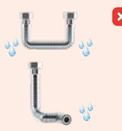
Compruebe periódicamente el estado de los componentes del flexible y sustitúyalos si hay daños o desgaste en la tubería o en los componentes. Si detecta algún deterioro, sustituya el producto.
