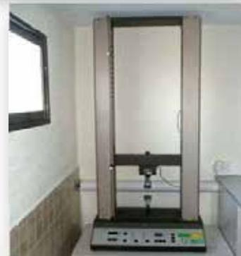
Ensayos de tracción, alargamiento y compresión
