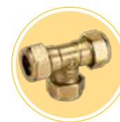
Te con adaptadores de tubo de cobre para instalación solar térmica. Conforme a la norma EN 1254-2. Campo de temperatura -20÷200 °C. Presión máxima de trabajo 10 bar.
