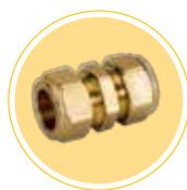
Manguito recto con adaptadores de tubo de cobre para instalación solar térmica. Conforme a la norma EN 1254-2. Campo de temperatura -20÷200 °C. Presión máxima de trabajo 10 bar.
