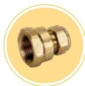
Rácor recto hembra con adaptador de tubo de cobre para instalación solar térmica. Conforme a la norma EN 1254-2. Campo de temperatura -20÷200 °C. Presión máxima de trabajo 10 bar.
