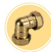
Codo 90 o con adaptadores de tubo de cobre para instalación solar térmica. Conforme a la norma EN 1254-2. Campo de temperatura -20÷200 °C. Presión máxima de trabajo 10 bar.
