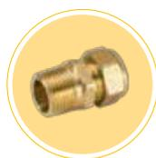
Rácor recto macho con adaptador de tubo de cobre para instalación solar térmica. Conforme a la norma EN 1254-2. Campo de temperatura -20÷200 °C. Presión máxima de trabajo 10 bar.
