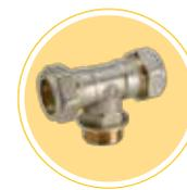
Te con adaptadores de tubo de cobre para instalación solar térmica y conexión central macho. Conforme a la norma EN 1254-2. Campo de temperatura -20÷200 °C. Presión máxima de trabajo 10 bar.
